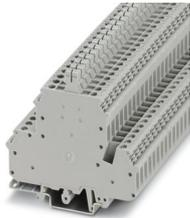
Trennklemme, mit Trennstecker, Nennspannung: 400 V, Nennstrom: 26 A, 1. Etage, Anschlussart: Schraubanschluss, Bemessungsquerschnitt: 4 mm<sup>2</sup>, Querschnitt: 0,2 mm<sup>2</sup> - 4 mm<sup>2</sup>, 2. Etage, Anschlussart: Schraubanschluss, Bemessungsquerschnitt: 4 mm<sup>2</sup>, Querschnitt: 0,2 mm<sup>2</sup> - 4 mm<sup>2</sup>, Montage: NS 35/7,5, NS 35/15, NS 32, Farbe: grau
