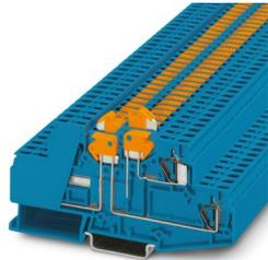
Messertrennklemme, Nennspannung: 400 V, Nennstrom: 16 A, 1. und 2. Etage, Anschlussart: Zugfederanschluss, Bemessungsquerschnitt: 1,5 mm<sup>2</sup>, Querschnitt: 0,2 mm<sup>2</sup> - 4 mm<sup>2</sup>, 2. Etage, Anschlussart: Zugfederanschluss, Bemessungsquerschnitt: 1,5 mm<sup>2</sup>, Querschnitt: 0,2 mm<sup>2</sup> - 4 mm<sup>2</sup>, Montage: NS 35/7,5, NS 35/15, Farbe: blau
