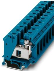
Installationsklemme, Nennspannung: 800 V, Nennstrom: 125 A, Schraubanschluss, Bemessungsquerschnitt: 35 mm<sup>2</sup>, Querschnitt: 0,75 mm<sup>2</sup> - 35 mm<sup>2</sup>, Montageart: NS 35/7,5, NS 35/15, NS 32, Farbe: blau
