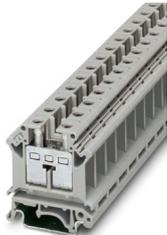
Installationsklemme, Nennspannung: 400 V, Nennstrom: 76 A, Schraubanschluss, Bemessungsquerschnitt: 16 mm<sup>2</sup>, Querschnitt: 2,5 mm<sup>2</sup> - 25 mm<sup>2</sup>, Montageart: NS 35/7,5, NS 35/15, NS 32, Farbe: grau
