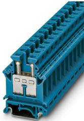
Durchgangsklemme, Nennspannung: 800 V, Nennstrom: 76 A, Anzahl der Anschlüsse: 2, Anschlussart: Schraubanschluss, Querschnitt: 0,5 mm<sup>2</sup> - 16 mm<sup>2</sup>, Montageart: NS 35/7,5, NS 35/15, NS 32, Farbe: blau
