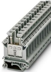
Durchgangsklemme, Nennspannung: 800 V, Nennstrom: 76 A, Anzahl der Anschlüsse: 2, Anschlussart: Schraubanschluss, Querschnitt: 0,5 mm<sup>2</sup> - 16 mm<sup>2</sup>, Montageart: NS 35/7,5, NS 35/15, NS 32, Farbe: grau
