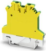
Schutzleiter-Reihenklemme, Anzahl der Anschlüsse: 2, Polzahl: 1, Anschlussart: Schraubanschluss, Querschnitt: 0,14 mm<sup>2</sup> - 1,5 mm<sup>2</sup>, Befestigungsart: PE-Fuß mit Befestigungsschraube, M2, Montageart: NS 35/7,5, NS 35/15, NS 32, Farbe: grün-gelb
