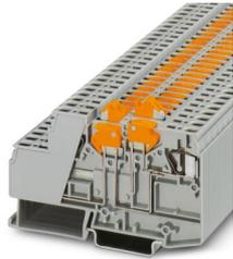
Messertrennklemme, Nennspannung: 400 V, Nennstrom: 16 A, 1. und 2. Etage, Anschlussart: Zugfederanschluss, Bemessungsquerschnitt: 1,5 mm<sup>2</sup>, Querschnitt: 0,2 mm<sup>2</sup> - 4 mm<sup>2</sup>, 2. Etage, Anschlussart: Zugfederanschluss, Bemessungsquerschnitt: 1,5 mm<sup>2</sup>, Querschnitt: 0,2 mm<sup>2</sup> - 4 mm<sup>2</sup>, Montage: NS 35/7,5, NS 35/15, Farbe: grau
