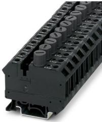
Sicherungsreihenklemme, Art der Sicherung: Glas / Keramik / ..., Sicherungstyp: G / 6,3 x 32, Nennspannung: 400 V, Nennstrom: 10 A, Anschlussart: Schraubanschluss, Querschnitt: 0,5 mm<sup>2</sup>- 16 mm<sup>2</sup>, Montageart: NS 35/7,5, NS 35/15, NS 32, Farbe: schwarz
