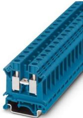
Durchgangsklemme, Nennspannung: 800 V, Nennstrom: 57 A, Anzahl der Anschlüsse: 2, Anschlussart: Schraubanschluss, Bemessungsquerschnitt: 10 mm<sup>2</sup>, Querschnitt: 0,5 mm<sup>2</sup> - 16 mm<sup>2</sup>, Montageart: NS 35/7,5, NS 35/15, NS 32, Farbe: blau
