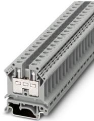
Durchgangsklemme, Nennspannung: 800 V, Nennstrom: 57 A, Anzahl der Anschlüsse: 2, Anschlussart: Schraubanschluss, Querschnitt: 0,5 mm<sup>2</sup> - 10 mm<sup>2</sup>, Montageart: NS 32, NS 35/7,5, NS 35/15, Farbe: grau
