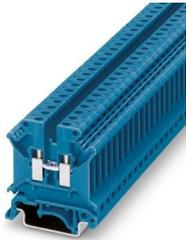
Durchgangsklemme, Nennspannung: 800 V, Nennstrom: 32 A, Anzahl der Anschlüsse: 2, Anschlussart: Schraubanschluss, Bemessungsquerschnitt: 4 mm<sup>2</sup>, Querschnitt: 0,2 mm<sup>2</sup> - 6 mm<sup>2</sup>, Montageart: NS 35/7,5, NS 35/15, NS 32, Farbe: blau
