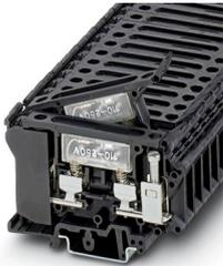
Sicherungsreihenklemme, Art der Sicherung: Glas / Keramik / ..., Sicherungstyp: G / 6,3 x 32, Nennspannung: 500 V, Nennstrom: 10 A, Polzahl: 1, Anschlussart: Schraubanschluss, Bemessungsquerschnitt: 1,5 mm<sup>2</sup>, Querschnitt: 0,5 mm<sup>2</sup>- 16 mm<sup>2</sup>, Montageart: NS 35/7,5, NS 35/15, NS 32, Farbe: schwarz
