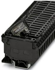
Sicherungsreihenklemme, Art der Sicherung: Glas / Keramik / ..., Sicherungstyp: G / 5 x 20 / 5 x 25 / 5 x 30, Nennspannung: 250 V, Nennstrom: 6,3 A, Polzahl: 1, Anschlussart: Schraubanschluss, Bemessungsquerschnitt: 4 mm<sup>2</sup>, Querschnitt: 0,2 mm<sup>2</sup>- 4 mm<sup>2</sup>, Montageart: NS 35/7,5, NS 35/15, NS 32, Farbe: schwarz
