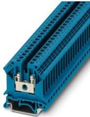
Durchgangsklemme, Nennspannung: 800 V, Nennstrom: 32 A, Anzahl der Anschlüsse: 2, Anschlussart: Schraubanschluss, Querschnitt: 0,2 mm<sup>2</sup> - 4 mm<sup>2</sup>, Montageart: NS 35/7,5, NS 35/15, NS 32, Farbe: blau
