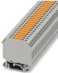
Messertrennklemme, mit Prüfbuchschrauben zur Aufnahme von Prüfsteckern, Nennspannung: 500 V, Nennstrom: 16 A, 1. Etage, Anschlussart: Schraubanschluss, Bemessungsquerschnitt: 2,5 mm<sup>2</sup>, Querschnitt: 0,2 mm<sup>2</sup> - 6 mm<sup>2</sup>, Montage: NS 35/7,5, NS 35/15, NS 32, Farbe: grau
