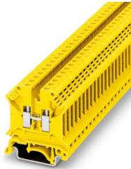
Durchgangsklemme, Nennspannung: 800 V, Nennstrom: 32 A, Anzahl der Anschlüsse: 2, Anschlussart: Schraubanschluss, Bemessungsquerschnitt: 4 mm<sup>2</sup>, Querschnitt: 0,2 mm<sup>2</sup> - 6 mm<sup>2</sup>, Montageart: NS 35/7,5, NS 35/15, NS 32, Farbe: gelb
