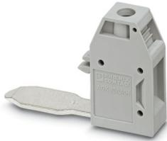
Abgriffklemme, Nennspannung: 1000 V, Nennstrom: 57 A, Anzahl der Anschlüsse: 1, Anschlussart: Schraubanschluss, Bemessungsquerschnitt: 10 mm<sup>2</sup>, Querschnitt: 0,5 mm<sup>2</sup> - 10 mm<sup>2</sup>, Montageart: auf Basiselement, Farbe: grau
