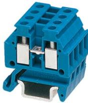
Mikroklemme, Nennspannung: 400 V, Nennstrom: 17,5 A, Anzahl der Anschlüsse: 2, Anschlussart: Schraubanschluss, Bemessungsquerschnitt: 1,5 mm<sup>2</sup>, Querschnitt: 0,14 mm<sup>2</sup> - 1,5 mm<sup>2</sup>, Montageart: NS 15, Farbe: blau
