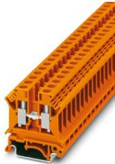
Durchgangsklemme, Nennspannung: 800 V, Nennstrom: 41 A, Anzahl der Anschlüsse: 2, Polzahl: 1, Anschlussart: Schraubanschluss, Bemessungsquerschnitt: 6 mm<sup>2</sup>, Querschnitt: 0,2 mm<sup>2</sup> - 10 mm<sup>2</sup>, Montageart: NS 35/7,5, NS 35/15, Farbe: orange
