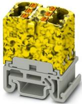
Verteilerblock, intern gebrückt, Nennspannung: 500 V, Nennstrom: 17,5 A, Anzahl der Anschlüsse: 6, Anschlussart: Push-in-Anschluss, Querschnitt: 0,14 mm<sup>2</sup> - 2,5 mm<sup>2</sup>, Montageart: NS 15, Farbe: schwarz/gelb
