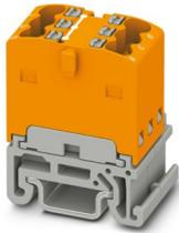
Verteilerblock, intern gebrückt, Nennspannung: 500 V, Nennstrom: 17,5 A, Anzahl der Anschlüsse: 6, Anschlussart: Push-in-Anschluss, Querschnitt: 0,14 mm<sup>2</sup> - 2,5 mm<sup>2</sup>, Montageart: NS 15, Farbe: orange
