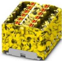
Verteilerblock, intern gebrückt, Nennspannung: 450 V, Nennstrom: 17,5 A, Anzahl der Anschlüsse: 12, Anschlussart: Push-in-Anschluss, Querschnitt: 0,14 mm<sup>2</sup> - 2,5 mm<sup>2</sup>, Montageart: kleben, Farbe: schwarz/gelb
