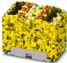
Verteilerblock, intern gebrückt, Nennspannung: 450 V, Nennstrom: 17,5 A, Anzahl der Anschlüsse: 6, Anschlussart: Push-in-Anschluss, Querschnitt: 0,14 mm<sup>2</sup> - 2,5 mm<sup>2</sup>, Montageart: kleben, Farbe: schwarz/gelb
