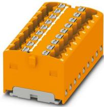
Verteilerblock, intern gebrückt, Nennspannung: 450 V, Nennstrom: 17,5 A, Anzahl der Anschlüsse: 18, Anschlussart: Push-in-Anschluss, Querschnitt: 0,14 mm<sup>2</sup> - 2,5 mm<sup>2</sup>, Montageart: kleben, Farbe: orange
