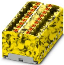
Verteilerblock, intern gebrückt, Nennspannung: 450 V, Nennstrom: 17,5 A, Anzahl der Anschlüsse: 18, Anschlussart: Push-in-Anschluss, Querschnitt: 0,14 mm<sup>2</sup> - 2,5 mm<sup>2</sup>, Montageart: aufrasten auf Tragschienenadapter, Direktmontage mit Flansch, Fliegend, Farbe: schwarz/gelb
