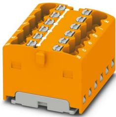
Verteilerblock, intern gebrückt, Nennspannung: 450 V, Nennstrom: 17,5 A, Anzahl der Anschlüsse: 12, Anschlussart: Push-in-Anschluss, Querschnitt: 0,14 mm<sup>2</sup> - 2,5 mm<sup>2</sup>, Montageart: aufrasten auf Tragschienenadapter, Direktmontage mit Flansch, Fliegend, Farbe: orange
