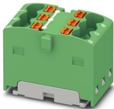
Verteilerblock, intern gebrückt, Nennspannung: 450 V, Nennstrom: 17,5 A, Anzahl der Anschlüsse: 6, Anschlussart: Push-in-Anschluss, Querschnitt: 0,14 mm<sup>2</sup> - 2,5 mm<sup>2</sup>, Montageart: aufrasten auf Tragschienenadapter, Direktmontage mit Flansch, Fliegend, Farbe: grün
