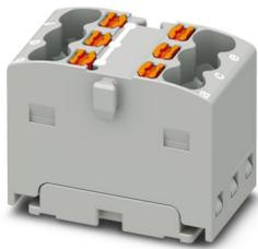
Verteilerblock, Grundklemme ohne Schutzleiterfunktion, Nennspannung: 450 V, Nennstrom: 17,5 A, Anzahl der Anschlüsse: 6, Anschlussart: Push-in-Anschluss, Querschnitt: 0,14 mm<sup>2</sup> - 2,5 mm<sup>2</sup>, Montageart: aufrasten auf Tragschienenadapter, Direktmontage mit Flansch, Fliegend, Farbe: grau
