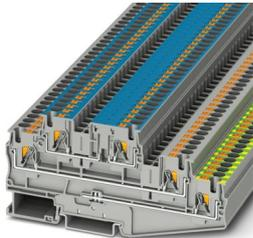
Mehrstockklemme, Nennspannung: 500 V, Nennstrom: 30 A, Anzahl der Anschlüsse: 5, Anschlussart: Push-in-Anschluss, Bemessungsquerschnitt: 4 mm<sup>2</sup>, Querschnitt: 0,2 mm<sup>2</sup> - 6 mm<sup>2</sup>, Anschlussart: Push-in-Anschluss, Bemessungsquerschnitt: 4 mm<sup>2</sup>, Querschnitt: 0,2 mm<sup>2</sup> - 6 mm<sup>2</sup>, Montageart: NS 35/7,5, NS 35/15, Farbe: grau
