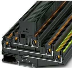
Sicherungsreihenklemme, Art der Sicherung: Glas / Keramik / ..., Sicherungstyp: G / 5 x 20, Nennspannung: 250 V, Nennstrom: 6,3 A, Anschlussart: Push-in-Anschluss, Bemessungsquerschnitt: 4 mm<sup>2</sup>, Querschnitt: 0,2 mm<sup>2</sup>- 6 mm<sup>2</sup>, Anschlussart: Push-in-Anschluss, Querschnitt: 0,2 mm<sup>2</sup>- 6 mm<sup>2</sup>, Montageart: NS 35/7,5, NS 35/15, Farbe: schwarz
