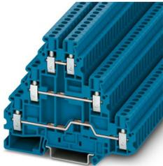
Mehrstockklemme, Nennspannung: 500 V, Nennstrom: 19 A, Anschlussart: Schraubanschluss, Bemessungsquerschnitt: 2,5 mm<sup>2</sup>, Querschnitt: 0,14 mm<sup>2</sup> - 4 mm<sup>2</sup>, Montageart: NS 35/7,5, NS 35/15, Farbe: blau
