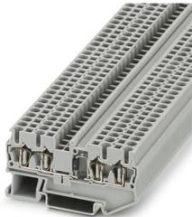
Bauelementreihenklemme, mit eingebauter Diode 1N 5408K, Nennstrom: 1,5 A, Anschlussart: Zugfederanschluss, Bemessungsquerschnitt: 2,5 mm<sup>2</sup>, Querschnitt: 0,08 mm<sup>2</sup> - 4 mm<sup>2</sup>, Montage: NS 35/7,5, NS 35/15, Farbe: grau
