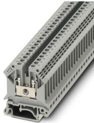
Durchgangsklemme, Nennspannung: 800 V, Nennstrom: 24 A, Anzahl der Anschlüsse: 2, Anschlussart: Schraubanschluss, 1. Etage, Querschnitt: 0,2 mm<sup>2</sup> - 4 mm<sup>2</sup>, Montageart: NS 32, NS 35/15, NS 35/7,5, Farbe: grau
