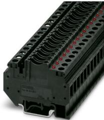
Sicherungsreihenklemme, Art der Sicherung: Flach, Sicherungstyp: C, Nennspannung: 12 V, Nennstrom: 30 A, Polzahl: 1, Anschlussart: Schraubanschluss, 1. Etage, Bemessungsquerschnitt: 4 mm<sup>2</sup>, Querschnitt: 0,2 mm<sup>2</sup>- 10 mm<sup>2</sup>, Montageart: NS 35/7,5, NS 35/15, NS 32, Farbe: schwarz
