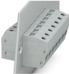
Durchführungsklemme, Anschlussart: Schraubanschluss mit Zughülse, Schraubanschluss mit Zughülse, Polzahl: 1, Belastungsstrom: 76 A, Querschnitt: 0,5 mm<sup>2</sup> - 25 mm<sup>2</sup>, Anschlussrichtung des Leiters zur Steckrichtung: 0 °, Breite: 12 mm, Farbe: grau
