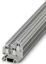
Mikroklemme, Nennspannung: 400 V, Nennstrom: 17,5 A, Anschlussart: Schraubanschluss, Bemessungsquerschnitt: 1,5 mm<sup>2</sup>, Querschnitt: 0,14 mm<sup>2</sup> - 1,5 mm<sup>2</sup>, Montageart: NS 15, Farbe: grau
