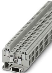
Mikroklemme, Nennspannung: 400 V, Nennstrom: 17,5 A, Anschlussart: Schraubanschluss, Bemessungsquerschnitt: 1,5 mm<sup>2</sup>, Querschnitt: 0,14 mm<sup>2</sup> - 1,5 mm<sup>2</sup>, Montageart: NS 15, Farbe: grau
