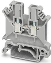
Durchgangsklemme, Nennspannung: 800 V, Nennstrom: 24 A, Anzahl der Anschlüsse: 2, Anschlussart: Schraubanschluss, Bemessungsquerschnitt: 2,5 mm<sup>2</sup>, Querschnitt: 0,2 mm<sup>2</sup> - 4 mm<sup>2</sup>, Montageart: NS 32, NS 35/15, NS 35/7,5, Farbe: grau
