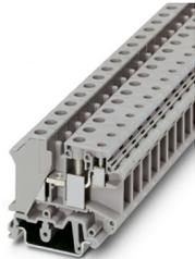
Durchgangsklemme, Nennspannung: 800 V, Nennstrom: 57 A, Anschlussart: Schraubanschluss, 1. Etage, Bemessungsquerschnitt: 10 mm<sup>2</sup>, Querschnitt: 0,5 mm<sup>2</sup> - 16 mm<sup>2</sup>, Schraubanschluss, 1. Etage Anschluss rechts, Bemessungsquerschnitt: 4 mm<sup>2</sup>, Querschnitt: 0,2 mm<sup>2</sup> - 6 mm<sup>2</sup>, Montageart: NS 35/7,5, NS 35/15, NS 32, Farbe: grau
