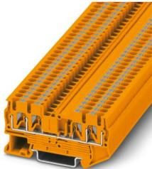
Durchgangsklemme, Nennspannung: 800 V, Nennstrom: 24 A, Anzahl der Anschlüsse: 4, Anschlussart: Push-in-Anschluss, Bemessungsquerschnitt: 2,5 mm<sup>2</sup>, Querschnitt: 0,14 mm<sup>2</sup> - 4 mm<sup>2</sup>, Montageart: NS 35/7,5, NS 35/15, Farbe: orange
