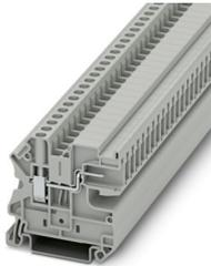
Durchgangsklemme, Nennspannung: 800 V, Nennstrom: 32 A, Anzahl der Anschlüsse: 2, Anschlussart: Schraub- / Steckanschluss, Bemessungsquerschnitt: 4 mm<sup>2</sup>, Querschnitt: 0,14 mm<sup>2</sup> - 6 mm<sup>2</sup>, Montageart: NS 35/7,5, NS 35/15, Farbe: grau
