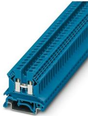
Durchgangsklemme, Nennspannung: 690 V, Nennstrom: 24 A, Anzahl der Anschlüsse: 2, Anschlussart: Schraubanschluss, Querschnitt: 0,2 mm<sup>2</sup> - 4 mm<sup>2</sup>, Montageart: NS 35/7,5, NS 35/15, Farbe: blau
