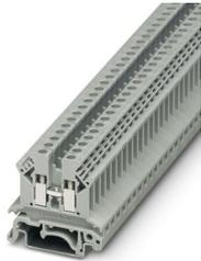
Durchgangsklemme, Nennspannung: 690 V, Nennstrom: 24 A, Anzahl der Anschlüsse: 2, Anschlussart: Schraubanschluss, Querschnitt: 0,2 mm<sup>2</sup> - 4 mm<sup>2</sup>, Montageart: NS 35/7,5, NS 35/15, Farbe: grau
