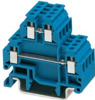
Mikroklemme, Nennspannung: 400 V, Nennstrom: 17,5 A, Anschlussart: Schraubanschluss, 1. und 2. Etage, Bemessungsquerschnitt: 1,5 mm<sup>2</sup>, Querschnitt: 0,14 mm<sup>2</sup> - 1,5 mm<sup>2</sup>, Montageart: NS 15, NS 35/7,5, NS 35/15, Farbe: blau
