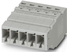
COMBI-Kupplung, Nennspannung: 1000 V, Nennstrom: 41 A, Anzahl der Anschlüsse: 2, Polzahl: 5, Anschlussart: Push-in-Anschluss, Bemessungsquerschnitt: 6 mm<sup>2</sup>, 1. Etage, Querschnitt: 0,5 mm<sup>2</sup> - 10 mm<sup>2</sup>, Farbe: grau
