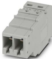
COMBI-Kupplung, Nennspannung: 1000 V, Nennstrom: 41 A, Anzahl der Anschlüsse: 2, Polzahl: 2, Anschlussart: Push-in-Anschluss, Bemessungsquerschnitt: 6 mm<sup>2</sup>, 1. Etage, Querschnitt: 0,5 mm<sup>2</sup> - 10 mm<sup>2</sup>, Farbe: grau
