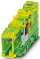
COMBI-Kupplung, Nennspannung: 1000 V, Nennstrom: 41 A, Anzahl der Anschlüsse: 2, Polzahl: 1, Anschlussart: Push-in-Anschluss, Bemessungsquerschnitt: 6 mm<sup>2</sup>, 1. Etage, Querschnitt: 0,5 mm<sup>2</sup> - 10 mm<sup>2</sup>, Farbe: grün/gelb
