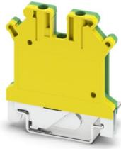
Schutzleiter-Reihenklemme, Anzahl der Anschlüsse: 2, Polzahl: 1, Anschlussart: Schraubanschluss, Querschnitt: 0,2 mm<sup>2</sup> - 4 mm<sup>2</sup>, Befestigungsart: PE-Fuß mit Befestigungsschraube, M2,5, Montageart: NS 35/7,5, NS 35/15, NS 32, Farbe: grün-gelb
