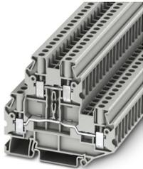
Doppelstockklemme, Nennspannung: 1000 V, Nennstrom: 30 A, Anschlussart: Schraubanschluss, Bemessungsquerschnitt: 4 mm<sup>2</sup>, Querschnitt: 0,14 mm<sup>2</sup> - 6 mm<sup>2</sup>, Montageart: NS 35/7,5, NS 35/15, Farbe: grau
